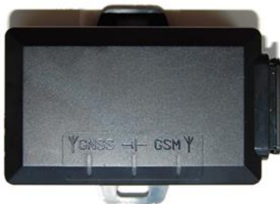
Рис. 1.1. Внешний вид блока мониторинга ВЕГА МТ-31.
